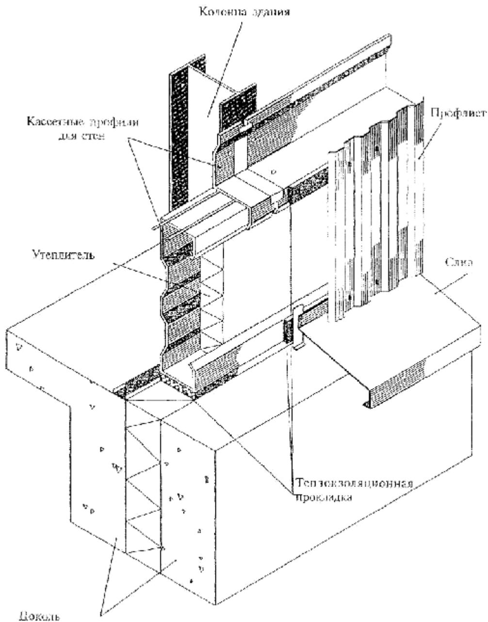
Рис. 6Б. Применение профилированного настила кассетного типа в конструкции стены
