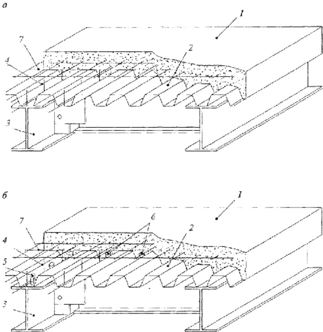
Рис. 7Б. Применение профнастила в качестве опалубки: *а* — профлист выполняет функцию опалубки для бетонного перекрытия; *б* — профлист одновременно выполняет функцию опалубки и несущую функцию совместно с бетонным перекрытием; 1 — бетон плиты; 2 — профлист; 3 — главная балка перекрытия; 4 — арматурный каркас; 5 — упоры по главной балке для объединения плиты с профлистом; 6 — упоры по второстепенной балке для объединения плиты с профлистом; 7 — противоусадочная сетка
