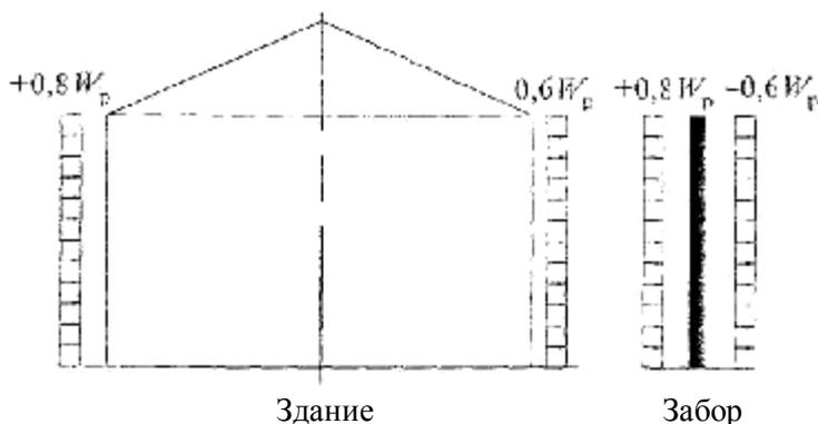
Рис 3. Действие ветра на вертикальные поверхности строительных объектов
