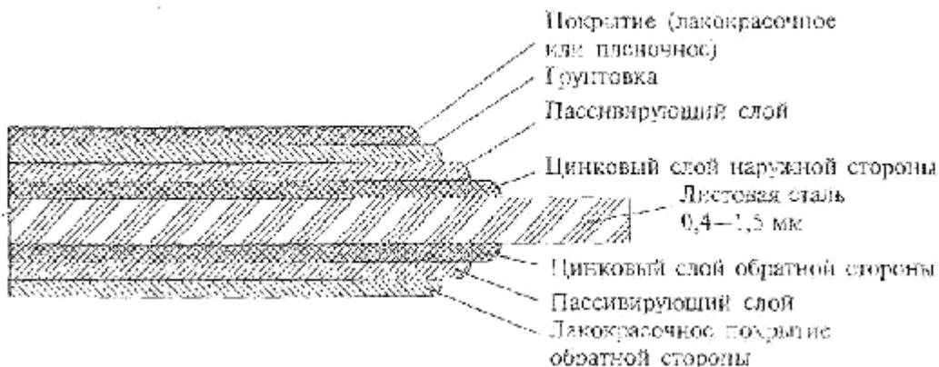
Рис. 1. Двойная система защиты стали от коррозии
