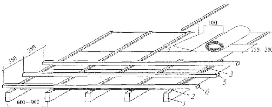
Рис. 6. Обрешетка и гидроизоляция: 1 — стропила; 2 — промежуточная обрешетка; 3 — контробрешетка; 4 — гидроизоляция; 5 — обрешетка; 6 — начальная обрешетка
